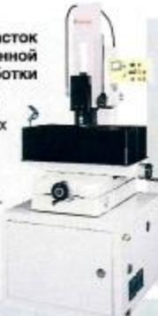
**Назначение:** Вырезание, прошивание, доводка, обработка сложнопровильных поверхностей деталей.
